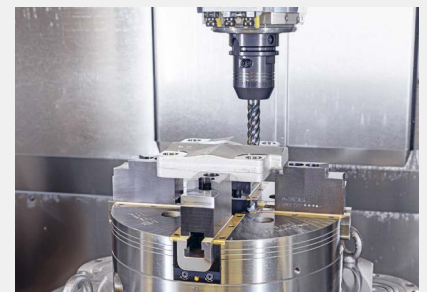
Mit dem Vier-Backen-Handspannfutter ROTA-M flex 2+2 vereint SCHUNK die Vorteile und Funktionen von Zwei-, Drei- und Vier-Backenfütern in der Werkstückbearbeitung.
